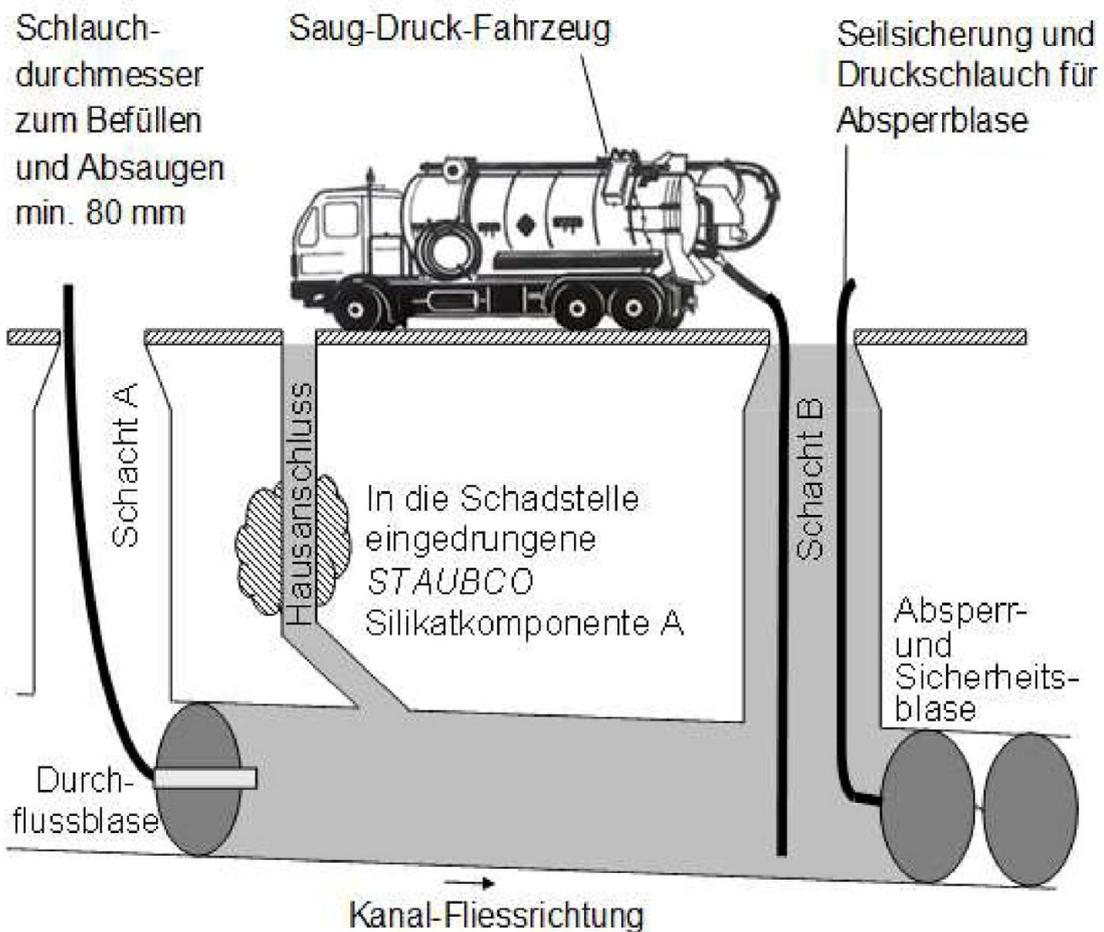
Bauprodukte und deren Verwendung zur Ausführung von Zwei-Komponenten-Injektionslösungen mit der Bezeichnung "STAUBCO" zur Sanierung von schadhafte, erdverlegten Abwasserkanälen und -leitungen in den Nennweiten DN 100 bis 500
